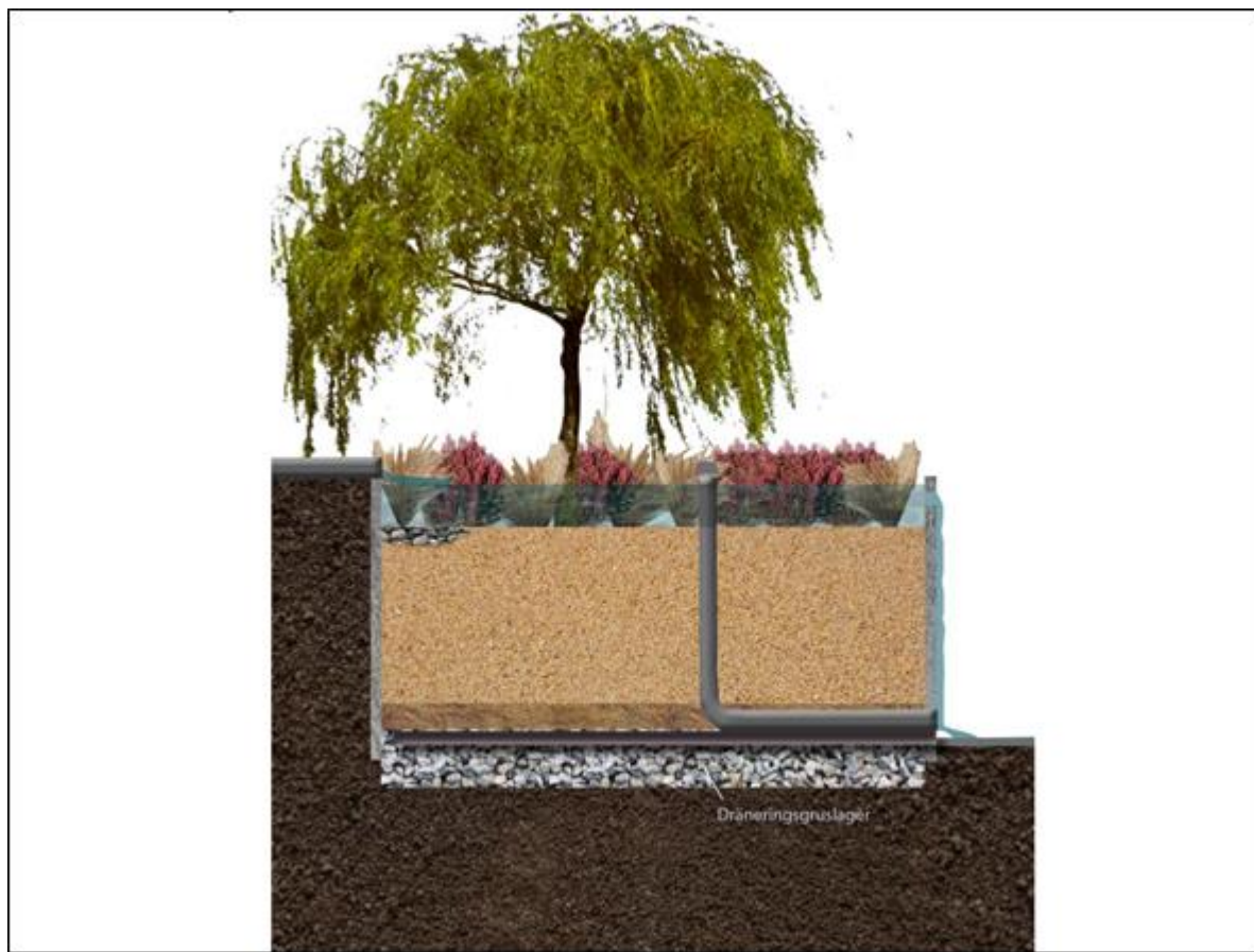
Figur 6-10. Exempel på uppbyggnad av biofilter i form av en regnbädd.
